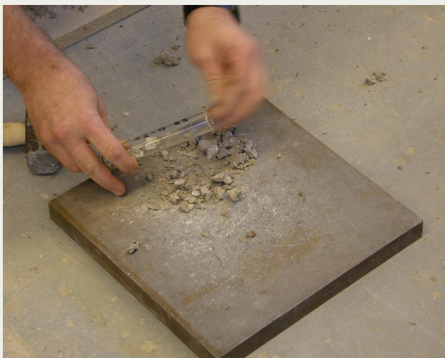
Fig 2. Uttagning av provbitar vilka placeras i glasrör som förseglas med gummikork i väntan på RF-mätning.
