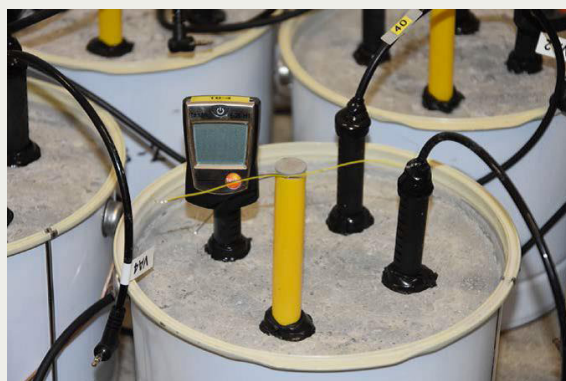
Fig 1. Spannar med RF-givare monterade. Från vänster, Testo 605-H1, HumiGuard, Vaisala HMP44-Pico och Vaisala HMP110.
